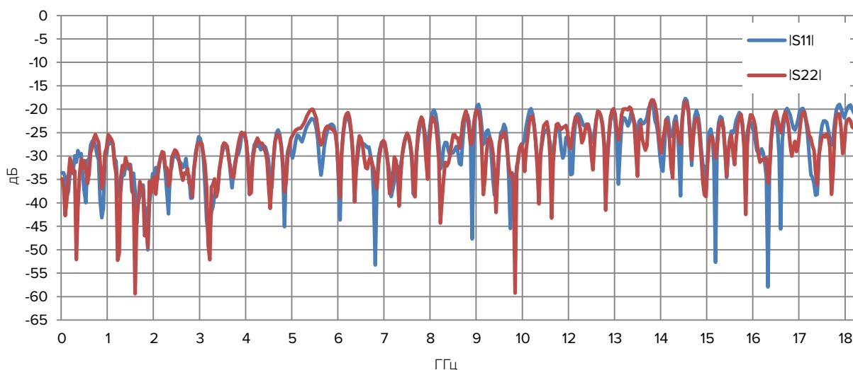
**Вносимые потери (ослабление входной мощности СВЧ-сигнала из-за неидеальности передающего тракта)**
