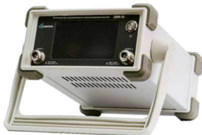
Аттенюаторы серии Д6М предназначены для ослабления мощности СВЧ-сигнала в диапазоне от 0 до 81 дБ с шагом 1 дБ. Диапазон рабочих частот от 0 до 26,5 ГГц.
